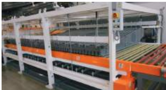
Stazione tempera / Tempering section
