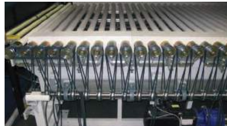
Movimentazione rulli ceramici con doppie cinghie Ceramic rollers handling by double belts
