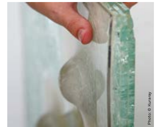
• Trosifol® Spallshield® CPET impact test
